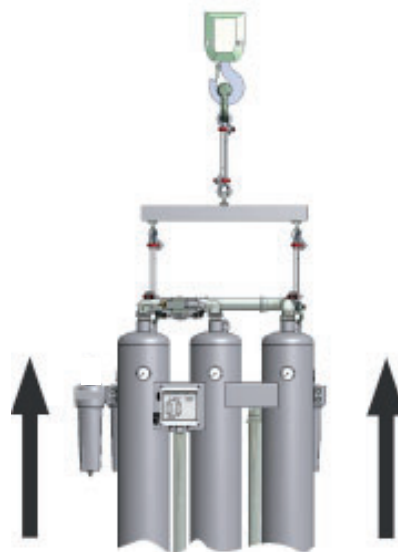
II: Colocación con grúa
